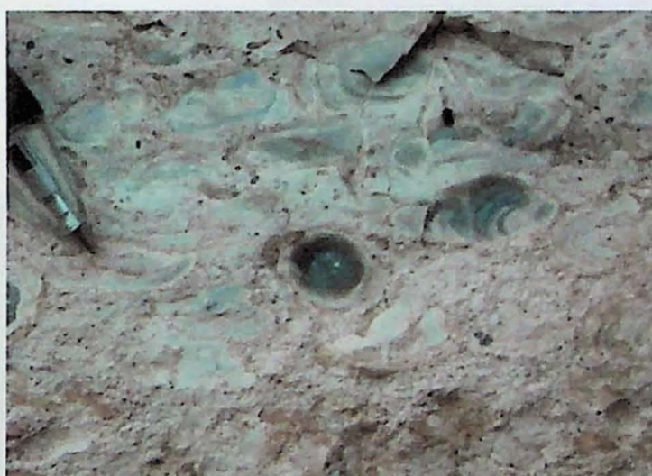
Figura 9: Silexito nodular com nódulos centimétricos de sílica.
